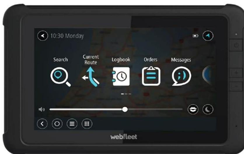
Das TomTom PRO 8475 ist mehr als nur ein Navigationsgerät. Es ist vielmehr ein Tablet mit einer vorinstallierten Navigations-App. Gegebenenfalls kann die Navigations-App auf die Werkseinstellungen zurückgesetzt werden, ohne dass andere Apps oder Einstellungen auf dem Gerät gelöscht werden.
